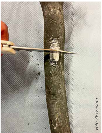
Blei oder nicht Blei – das ist hier die Frage. Ein einfacher Kratztest bringt schnell Klarheit in die Angelegenheit.
